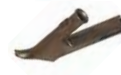
Насадка для быстрой сварки для круглого прутка. Насаживается на стандартную насадку. Ø3 мм - Art.-Nr. 5106989 Ø4 мм - Art.-Nr. 5106990 Ø5 мм - Art.-Nr. 5106991
